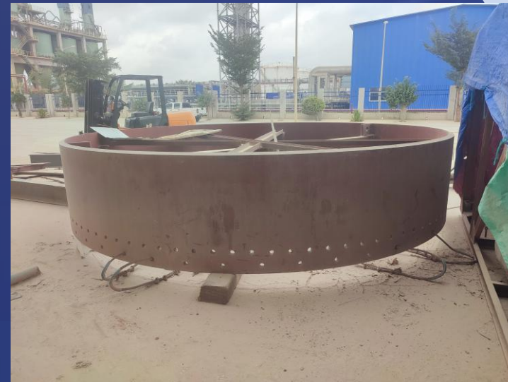
Virola salida horno rotatorio
