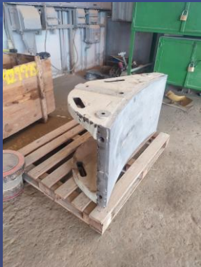
Zapata cojinete molino
